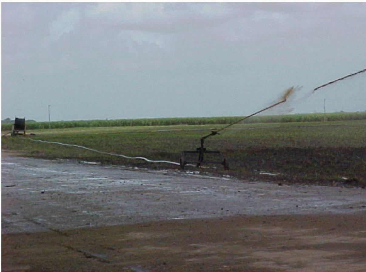
Figura 2. – Irrigação tipo autopropelido (carretel enrolador)
