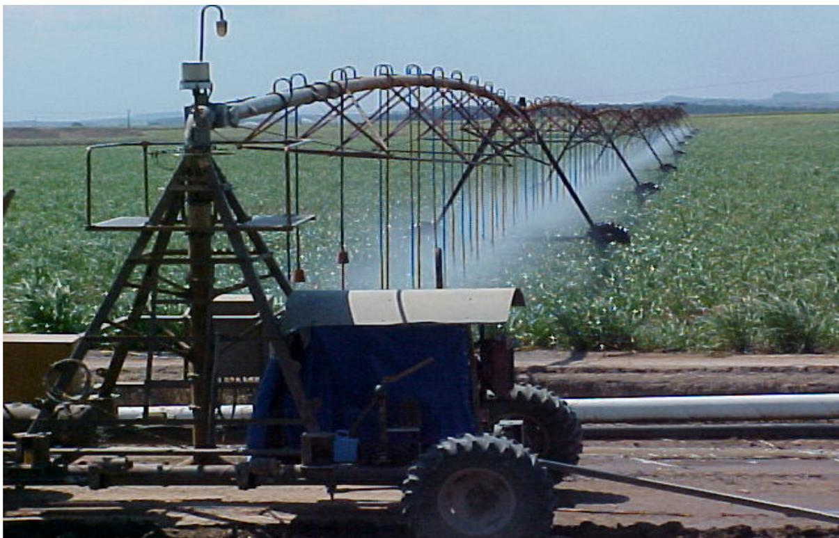
Figura 4. – Irrigação Linear móvel
